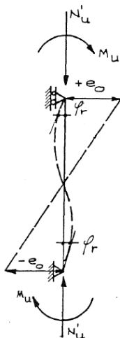
figuur 2 Situatie 2: twee gelijke kopmomenten en een lineair verlopende excentriciteit
